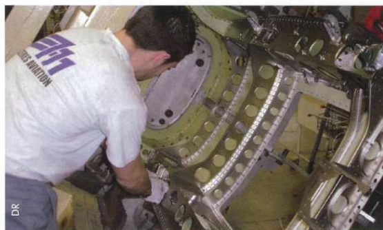
Assemblage de nacelle ATR, par la société Maz'Air.
