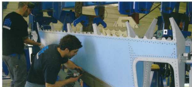
ASSEMBLAGE CARENE DE MAT A380 - MAZ'AIR EST SPÉCIALISÉE DANS LA FABRICATION DE WORK PACKAGES (ENSEMBLE) ET MAÎTRISE TOUTE LA CHAÎNE DE RÉALISATION DEPUIS L'ACHAT MATIÈRE JUSQU'À LA LIVRAISON CLIENT - PHOTO TOUS DROITS RESERVES
